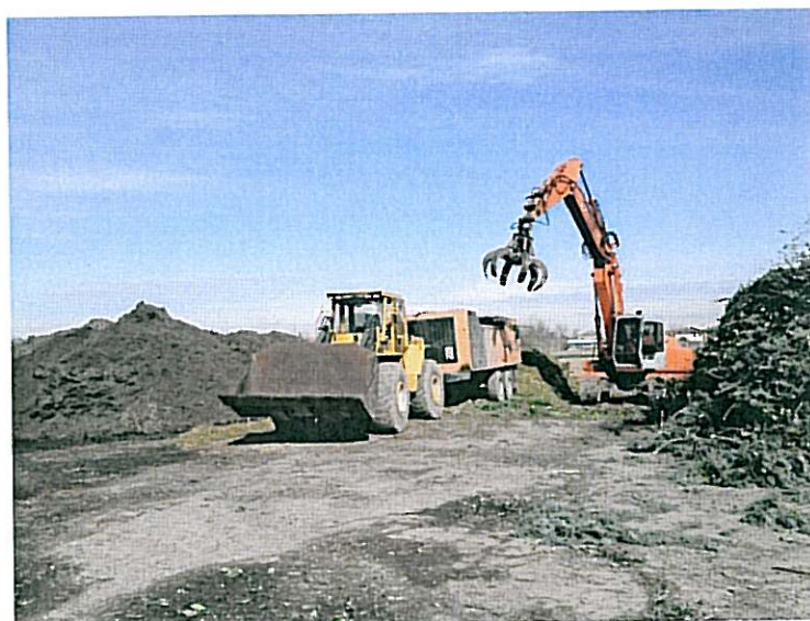
esempio carico del biotrituratore con escavatore dotato di ragno
