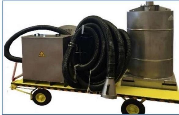
Figura 15 – Sistemi di aspirazione carrellati
