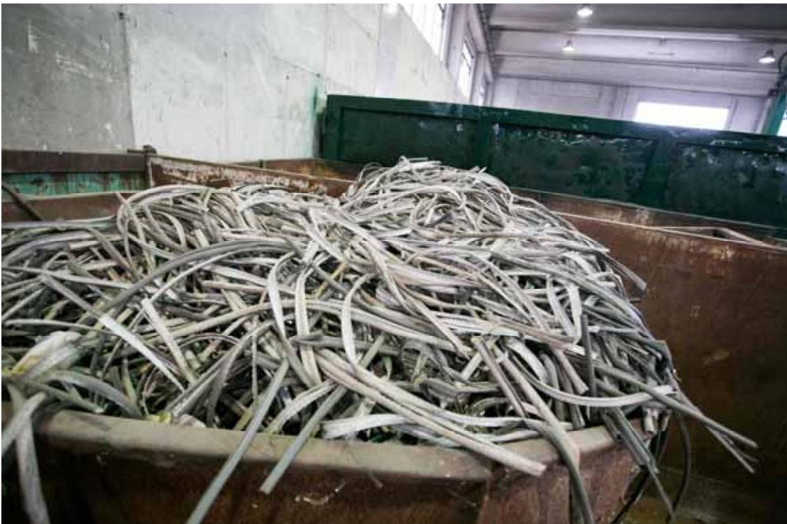
Foto 9: Rivestimento plastico rimosso dai cavi tramite pelacavi
