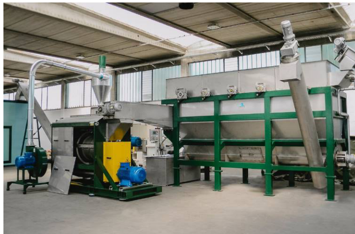
Figura 20 – esemplificativo vasche di lavaggio e flottazione
