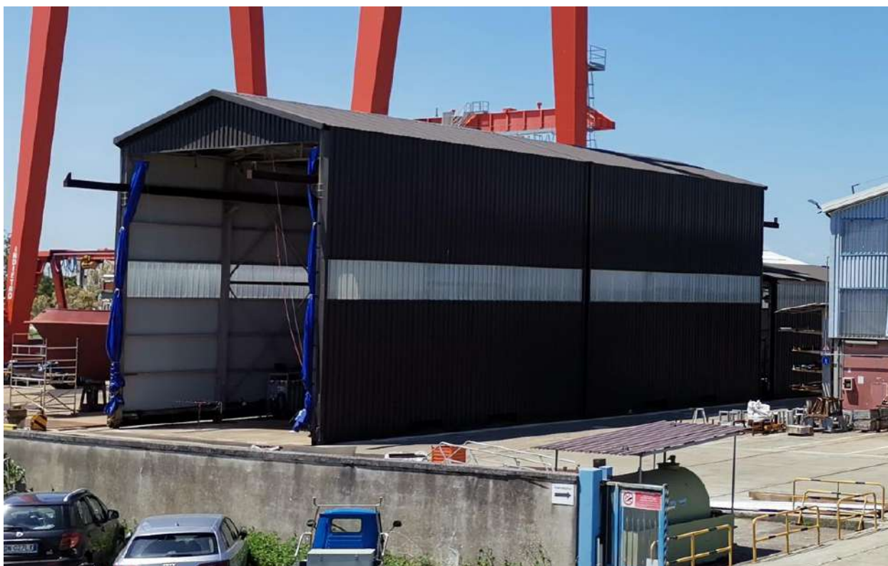
Struttura mobile che sarà spostata da progetto all'interno della quale avverranno le operazioni di sabbiatura
