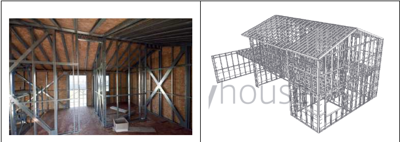
Struttura wire frame
