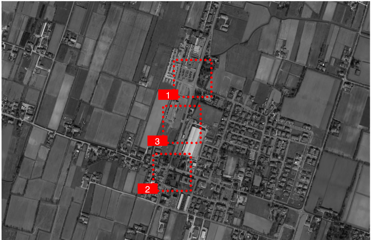
Figura 5.17 – Sezioni di rilievo tramite strumentazione radar
