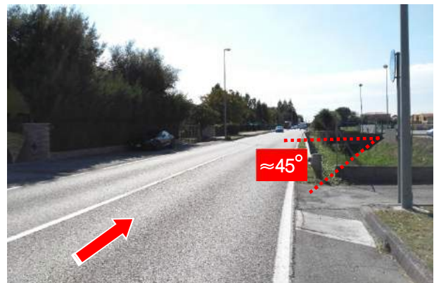
Figura 5.2 – Angolo di installazione dei radar rispetto alla direzione di marcia
