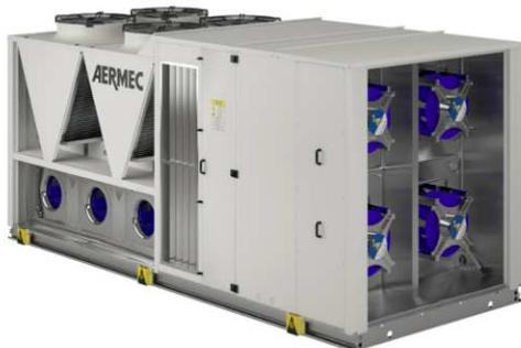
L'unità rooftop opera un parziale ricircolo dell'aria interna, riscaldandola o raffrescandola in base alle esigenze, mentre il restante volume d'aria viene espulso direttamente all'esterno e sostituito con aria nuova, che viene immessa nei locali per garantire il corretto ricambio dell'aria interna. Verrà sempre garantito il ricambio d'aria minimo richiesto dalla normativa vigente in materia (UNI 10339), calcolato in base alla superficie dell'area considerata e all'affollamento previsto.
