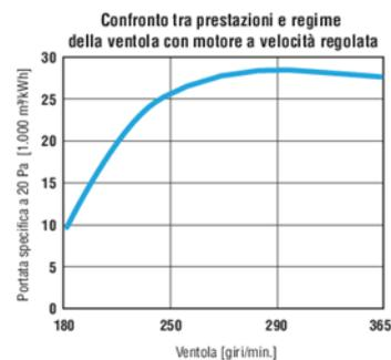
Le curve si riferiscono al motore EM50 50 Hz trifase a velocità regolabile da 1,0 CV.
