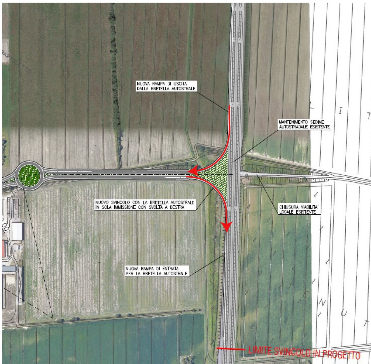
FIGURA 63 IPOTESI SVINCOLO SUD CON LA BRETELLA AUTOSTRADALE IN SOLA IMMISSIONE CON SVOLTA A DESTRA
