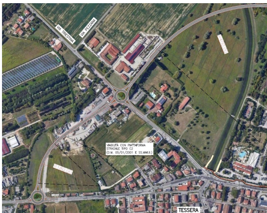
FIGURA 71: TRATTO IN CORRISPONDENZA DI VIA TRIESTINA: IPOTESI DI RISOLUZIONE MEDIANTE INTERSEZIONE A ROTATORIA TRA LA VIABILITÀ IN PROGETTO E LA VIABILITÀ LOCALE.
