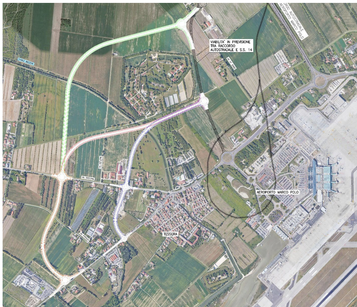
FIGURA 70: INDIVIDUAZIONE DELLE TRE ALTERNATIVE DI TRACCIATO PER IL BY-PASS DI TESSERA
