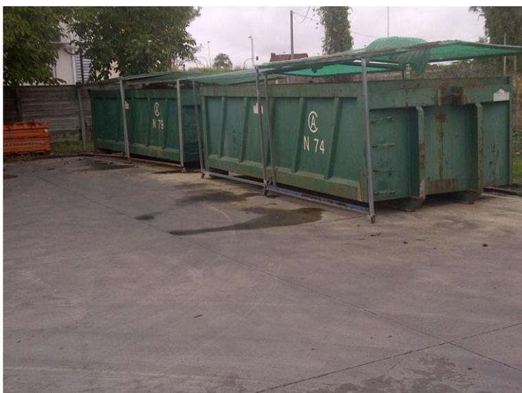
Foto 1 : stoccaggio fanghi filtropressati
