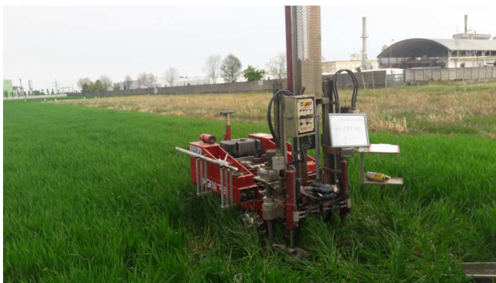
Esecuzione prova CPT RN1 su terreno naturale.
