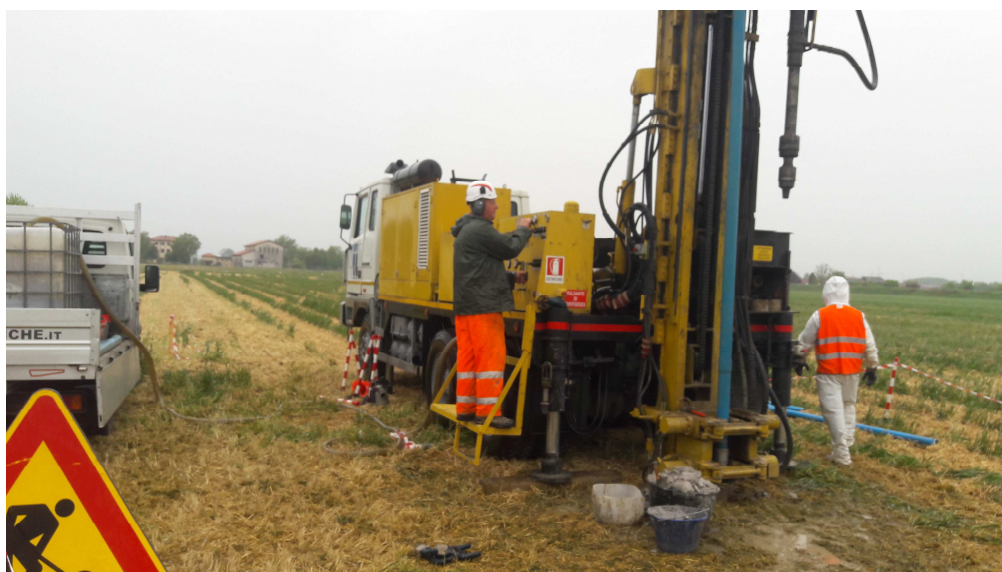
Sondaggio S2 (30 m) – posa tubo piezometrico a -15 m.
