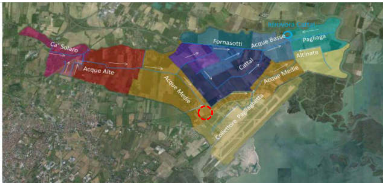
Figura 5-34: La rete di bonifica del bacino Cattal, a scolo meccanico, afferente all'omonima idrovora. Elaborazione in ambiente Google Earth con sfondo foto da satellite 2014.
