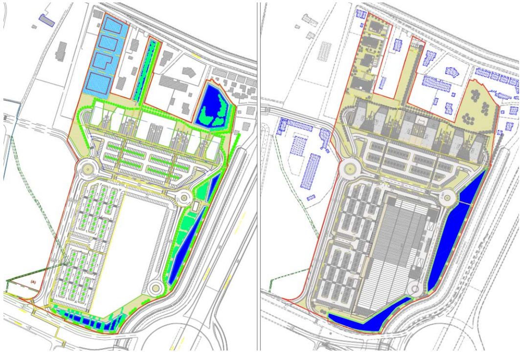
Figura 8 Modifiche del sistema di invaso per invarianza idraulica.
