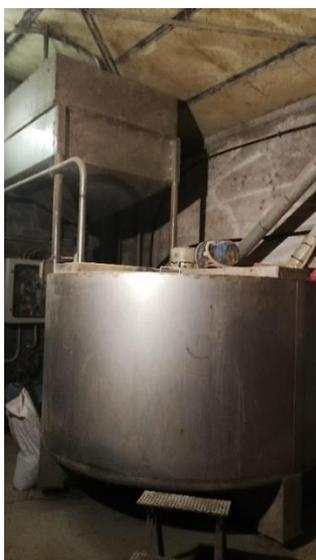
Foto 5 .Vasca in acciaio inox per la preparazione della broda su celle di carico
