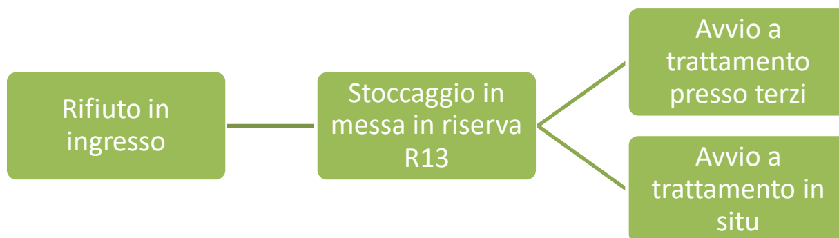
Figura 7 - Schema gestione rifiuti sottoposti alla messa in riserva R13
