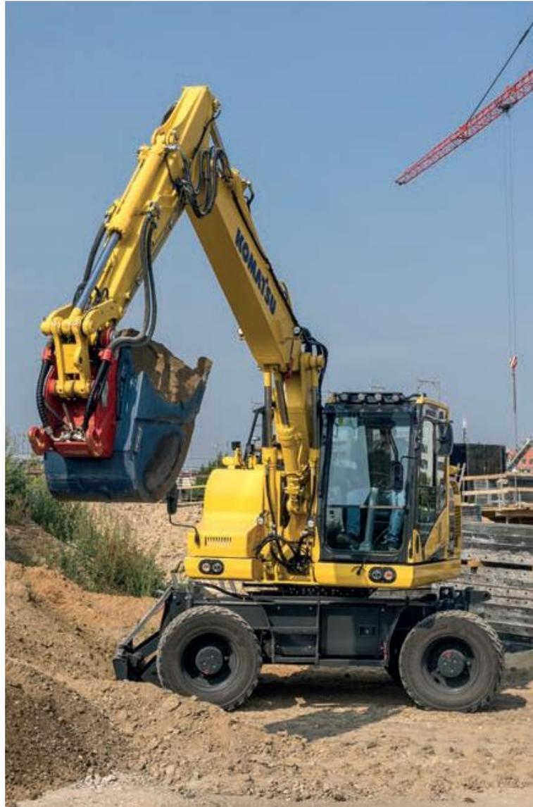
Foto 2 - escavatore Komatsu sul quale sarà montato un polipo al posto della benna
