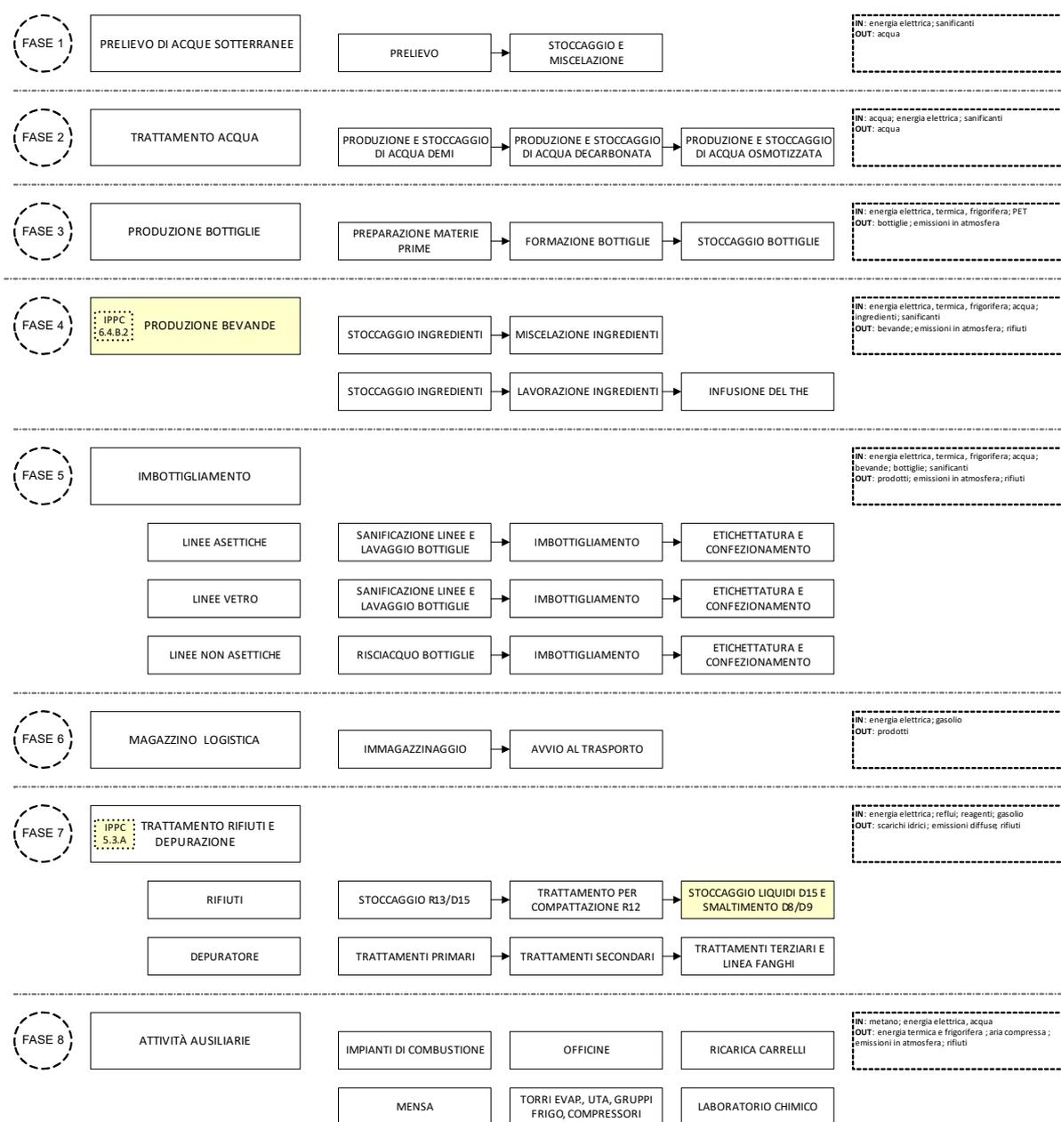
Figura 1.4 Schema a blocchi dei principali processi produttivi (nei blocchi tratteggiati sono indicati i principali elementi in entrata e in uscita)
