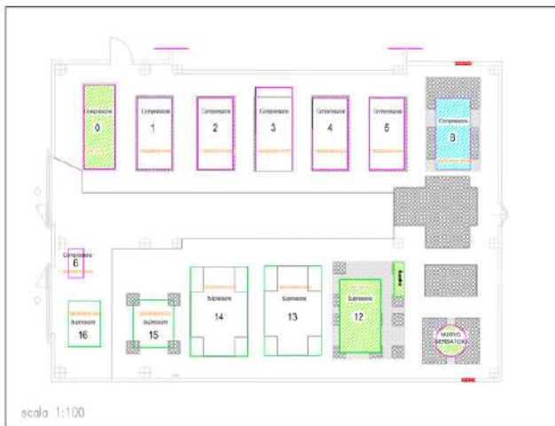
Figura 2.5 – Layout della sala compressori 1 (post revamping)
