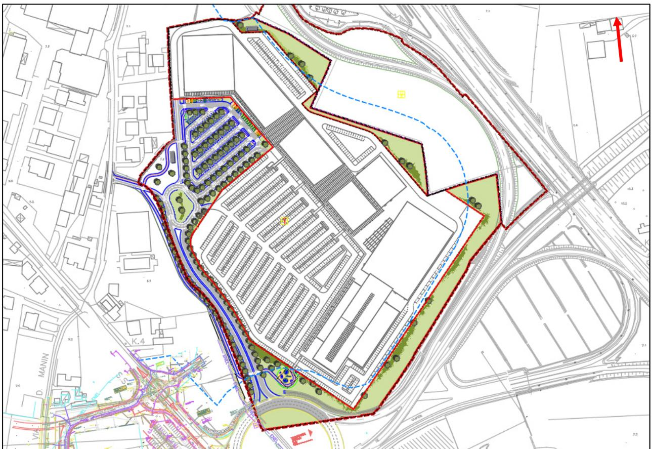
*Nuova viabilità di accesso e recesso al Centro Commerciale (progetto elaborato da PRO.TEC.O. Engineering s.r.l.).*
