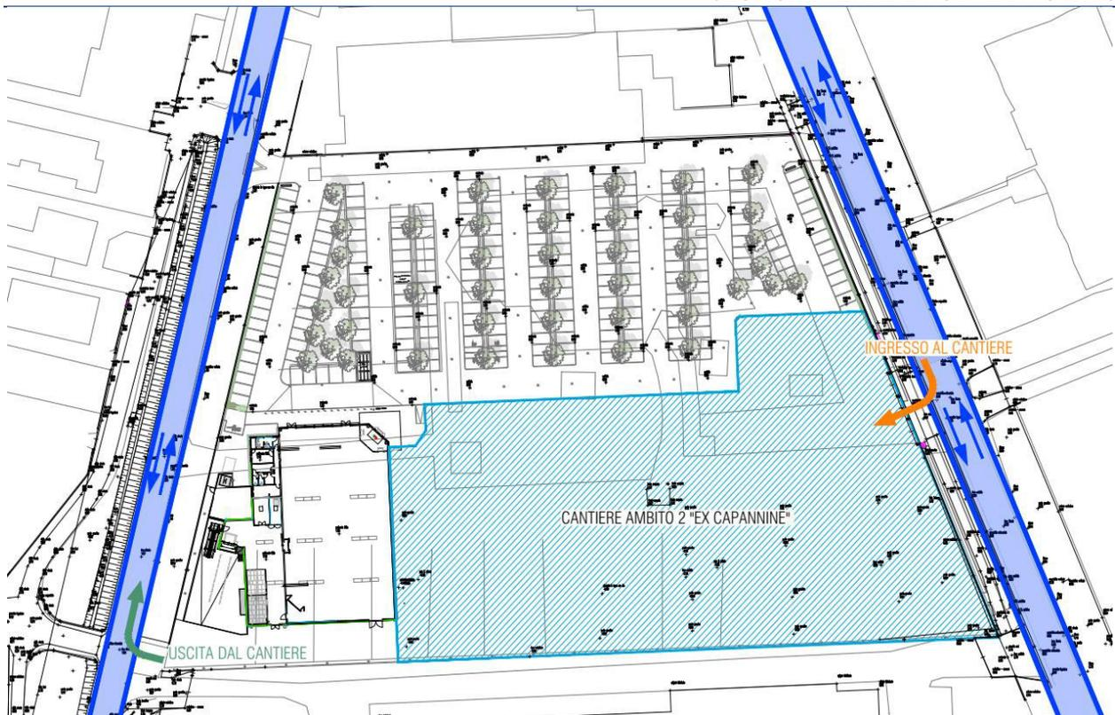
Figura 6 - Modalità di ingresso e uscita dei mezzi pesanti dall'ambito di cantiere del centro commerciale.
