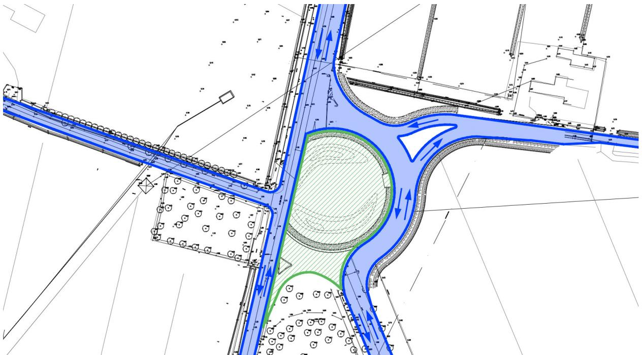
Figura 8 - Fase B.2 di cantiere (in verde); in blu la viabilità attività con i flussi di traffico.
