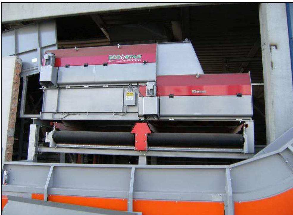
Fotografia 14 – Uscita del sovravaglio dal vaglio dinamico a dischi (civico n. 6)
