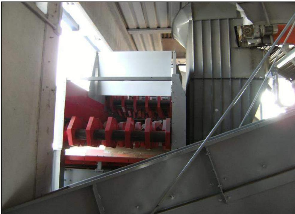
Fotografia 12 – Uscita posteriore del vaglio dinamico a dischi (civico n. 6)
