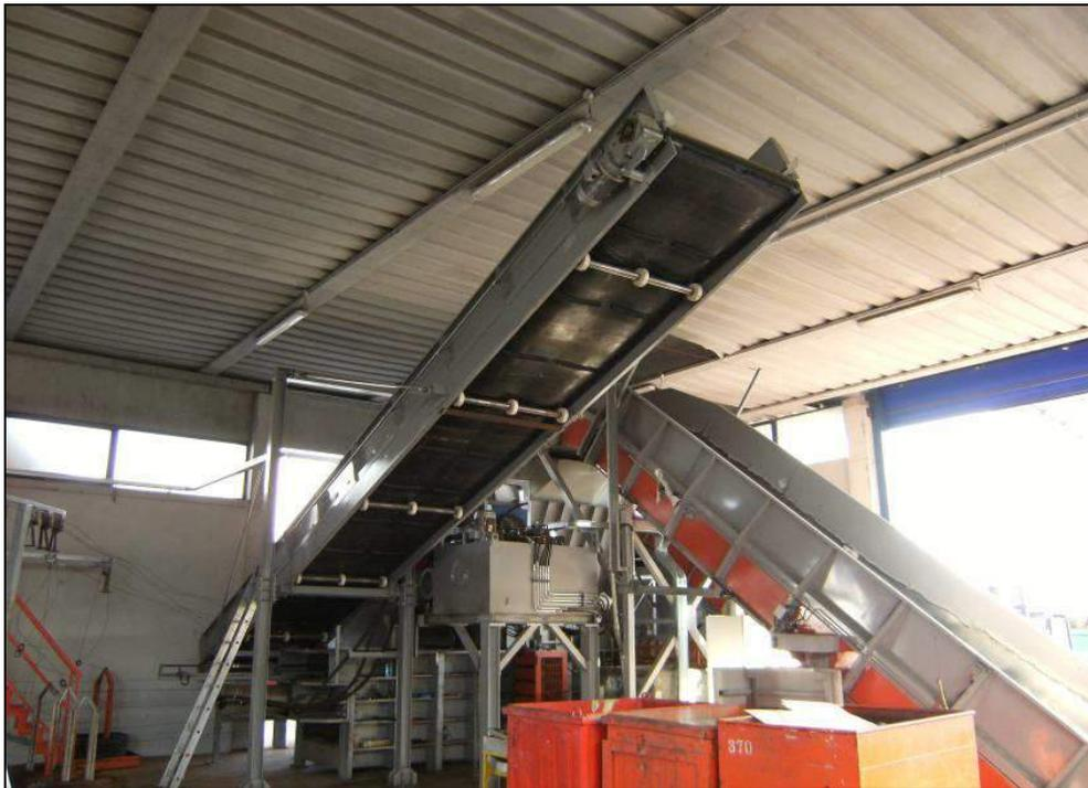
Fotografia 13 – Nastro trasportatore per l'allontanamento del sopravvaglio (civico n. 6)
