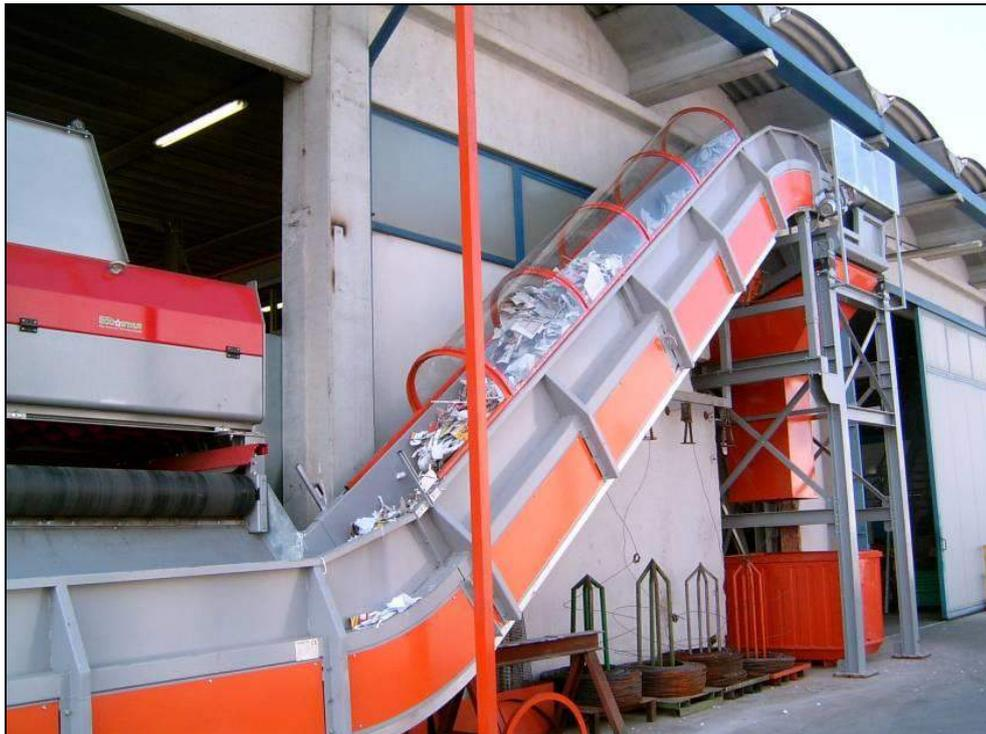
Fotografia 15 – Passaggio del sovrvallo dal vaglio a dischi al vibrovaglio dinamico (civico n. 6)
