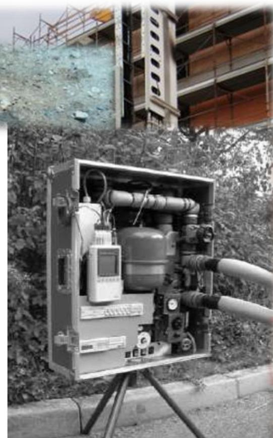
Figura 5.5 - Apparato utilizzato per il GRT (Università di Losanna)
